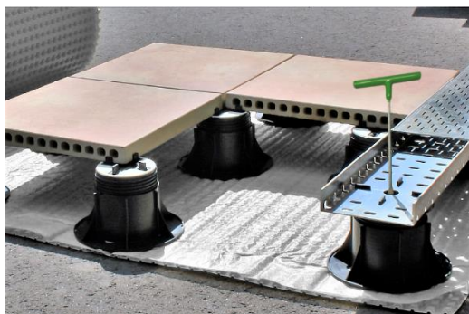
Abbildung 3: Verlegebeispiel: Drainmatte DRM entkoppelt die Stelzlager SK-V vom Untergrund und schützt diese vor Beschädigungen und Umwelteinflüssen. Das Oberflächenwasser kann durch die Fugen und die rechts verbaute VOLFI-Drainrinne 150mm fließen und wird von dem Spezialvlies effizient abgeleitet.
