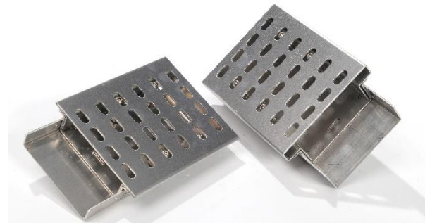
Abbildung 1: Drainrinnen DR-AV in 30-50mm (links) und 60-95mm (rechts) Verstellbereich. Stufenlos verstellbar durch in Gewindeklötze gelagerte Schrauben.
