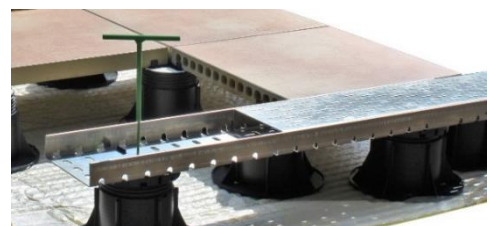
Abbildung 3: VOLFI Drainrost exemplarisch eingebaut in einen Plattenverbund. Entsprechende Kastenrinne und Volfiteller VT-B 4/10 erforderlich. Stelzen = SV-403; auf Drainmatte DRM
