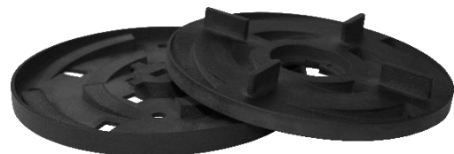
Abbildung 3: Zweiteilig mit keilförmiger, stufenweiser Rasterung zur Höhenverstellung im Bodenteller (rechts im Bild)
