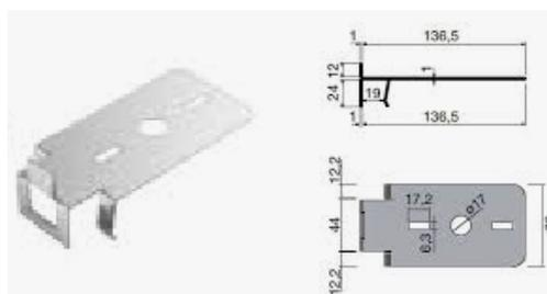
Abbildung 5: Abmessungen Stufenclip
