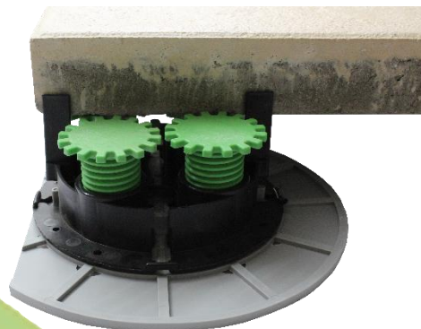
Abbildung 6: Das Schraub-Stelzlager ZR-V mit der VOLFI Bodenplatte gummiert 4/10 mit zwei gegenüberliegend entfernten Fugenstege und gekürzter Bodenplatte für die Randverlegung
