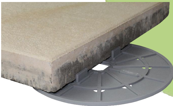
Abbildung 5: Die VOLFI Bodenplatte gummiert 4/10 mit zwei gegenüberliegend entfernten Fugenstege für die Randverlegung
