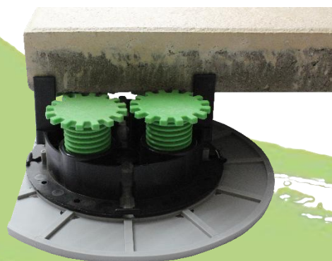
Abbildung 6: Das Schraub-Stelzlager ZR-V mit zwei gegenüberliegend entfernten Fugenstege und der VOLFI Bodenplatte gummiert 4/10 mit gekürzter Bodenplatte für die Randverlegung
