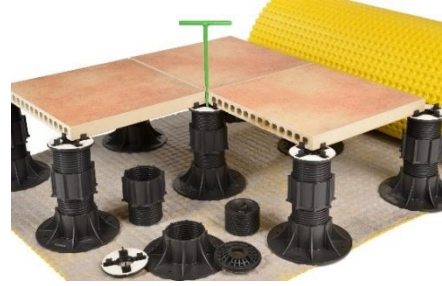
Abbildung 8: Verlegebsp.: SK-VN 403+1xVN-VL -> SK-VN 406 140-230mm verstellbar. Optional in Kombination mit Drainmatte DRM.
