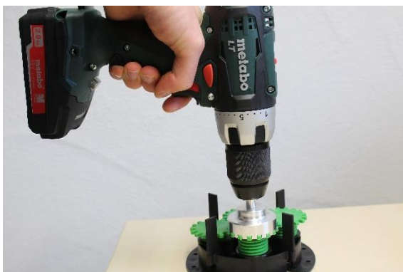
Abbildung 3: ZRV-A im Einsatz. Auch große Stückzahlen ZRV lassen sich in kurzer Zeit voreinstellen,
