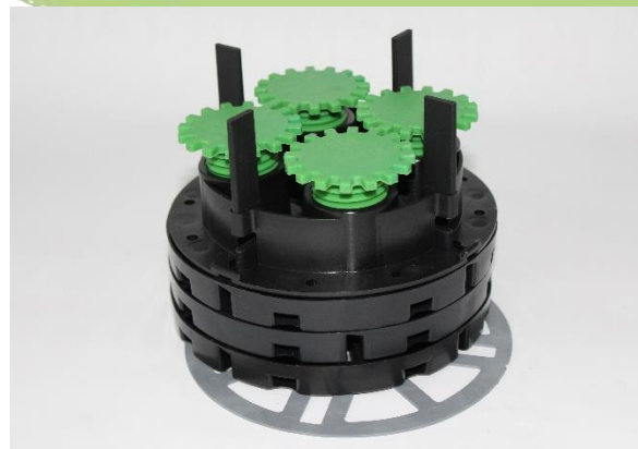
Abbildung 3: Drei Mal VT-B 15 mit aufgesetztem ZR-V und als Trittschalldämmung untergelegter VT-A 1mm. (Verstellbereich: 76-91mm) Achtung: VT-A vollflächig unterlegen!
