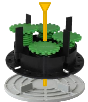
Abbildung 3: Alle Volfiplatten Ausführungen lassen sich als unterstes Element im Volfiteller System (wie hier) zur 5mm Erhöhung, bzw. als Entkopplung einsetzen.
