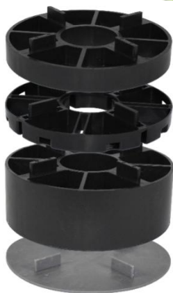
Abbildung 2: Alle Volfischeiben Ausführungen lassen sich als unterstes Element im Volfiteller System (wie hier) zur 2mm Erhöhung, bzw. als Entkopplung einsetzen.
