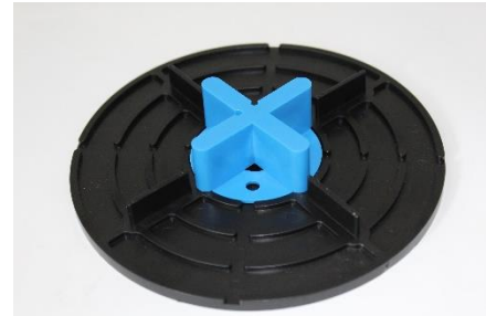
Abbildung 6: VP-U 4/10 mit mittig eingelegtem FK-B 6/22. Fugenbreite des FK-B hebt die 4er Fuge der Platte auf -> verarbeitbare Breite jetzt: 6mm
